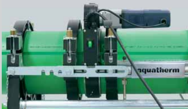
Dijelovi koje treba zavariti fiksiraju se i na odgovarajući način poravnavaju te se koristi glodalica
