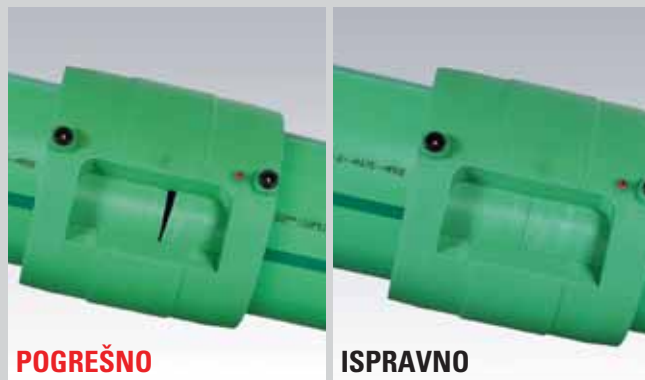
Za optimalan, stabilan rezultat zavarivanja preporučamo da se oba kraja cijevi unutar E-spojnice polože međusobno planparalelno! Obavezno poštivati minimalne dubine zavarivanja!
