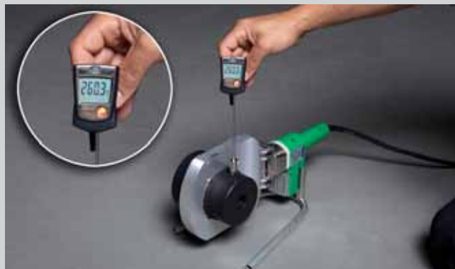
Mjerenje temperature na aquatherm aparatu za ručno zavarivanje (1400 W)
