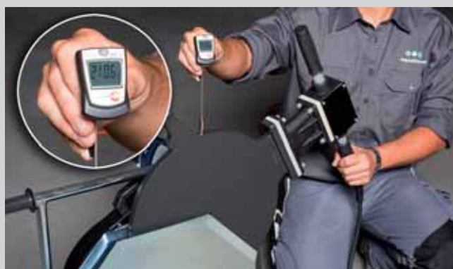
Mjerenje temperature na aquatherm stroju za zavarivanje
